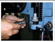
10. 在單腳等高座 C67201F 放 置砲塔頭左下方最佳已鑽 孔位置作 M5 攻牙 In one foot high C67201F
