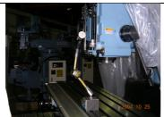
18. 用萬向磁座配槓桿百分 表吸著在工作床台對尺 體側面作上下垂直度校 進
