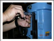
7. 在双腳等高座 C67202F 放 置砲塔頭上方最佳已鑽孔 位置作 M5 攻牙。
