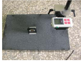
角度儀使用前必需在工作面先歸零
