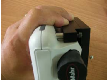
提供 4*M3 螺絲固鎖 SP1 本體狀況
