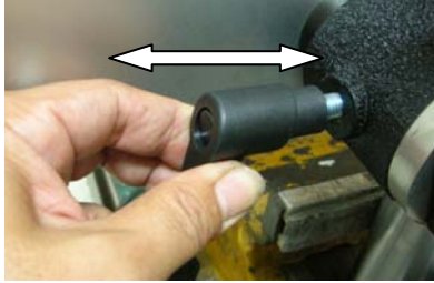
固鎖萬向 L 板扭欲調整方位向後拉
