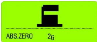
這個顯示圖形表示第一個讀數已經成功輸入，現在水平儀必須原地反轉 **180 度**，輕輕的滑動旋轉，不要提起來，然後放置在原先做記號的位置上按下 **zapper** 或是 **<ENTER>**，可以由液晶螢幕看到收集數據的過程。
