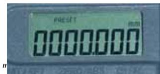
旋轉 **定壓鈕** 是數字 0-9 切換，短按一下 **A 鍵** 是位數的切換。預設完成後再 長按一下 回到歸零設定，在 短按一下 就回到正常使用狀態了。
