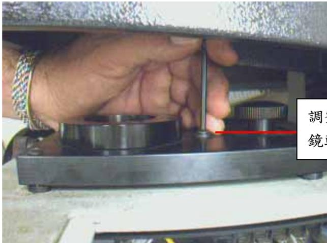
調整螺絲使光源位於正中但鏡頭必須拆下
