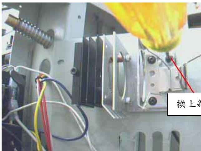
換上新的隔熱燈座並鎖緊
