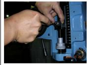
2. 將固定座 C270157 放置擋頭 作鑽孔定位 the holder C270157 place for drilling the first positioning block
