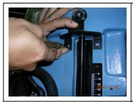
5. 將双腳等高座 C67202F 放 置砲塔頭上方最佳位置作 鑽孔定位
