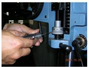
10. 在單腳等高座 C67201F 放 置砲塔頭左下方最佳已鑽 孔位置作 M5 攻牙
