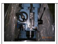
17. 尺體試裝調整合適後 用 M4 螺絲微上緊等高墊 M4 孔定位
