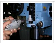
9. 在單腳等高座 C67201F 放 置砲塔頭左下方最佳位置 作鑽孔
