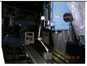
18. 用萬向磁座配槓桿百分 表吸著在工作床台對尺 體側面作上下垂直度校 準
