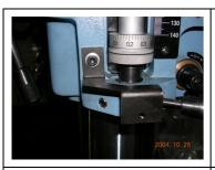
13. 將單腳等高座 C67201F 鎖 上砲塔頭左下方孔定位
