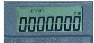
旋轉 **定壓鈕** 是數字 0-9 切換，短按一下 **A 鍵** 是位數的切換。預設完成後再 長按一下 回到歸零設定，再 短按一下 就回到正常使用狀態了。
