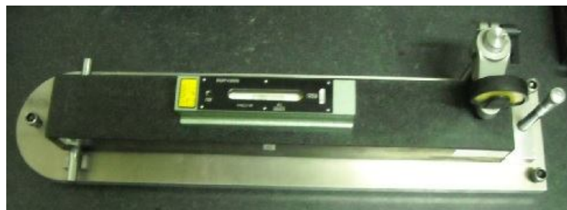
氣泡式水平儀歸正擺置(放中央)/校正檢查(放左邊基準位)
