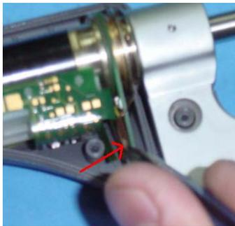
G. 鎖緊壓片固定電路板
